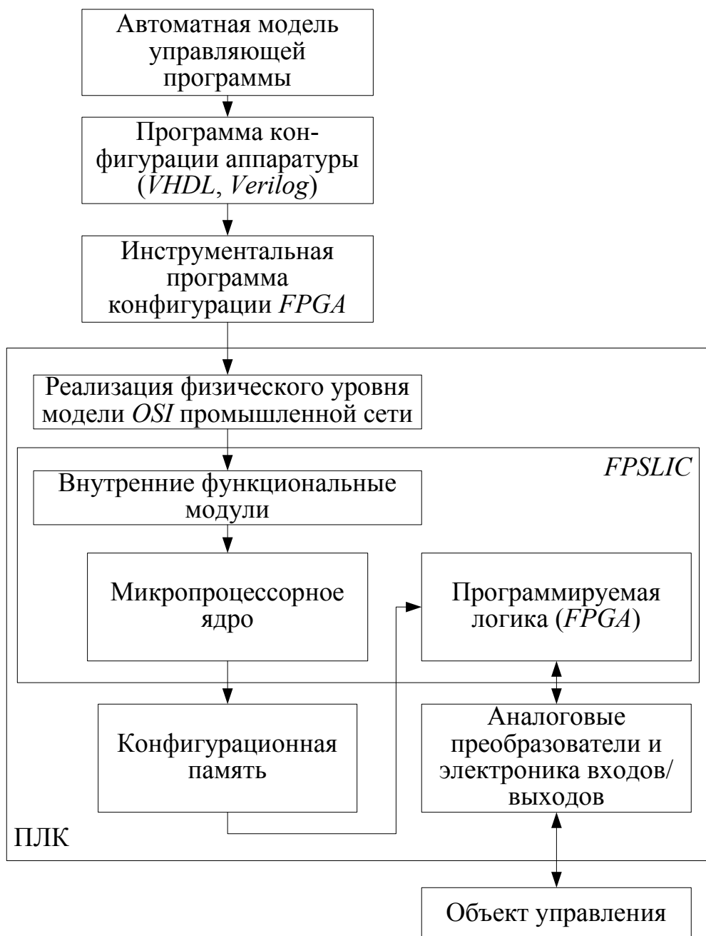
Рисунок 2 – Применение быстродействующего ПЛК на базе FPSLIC
