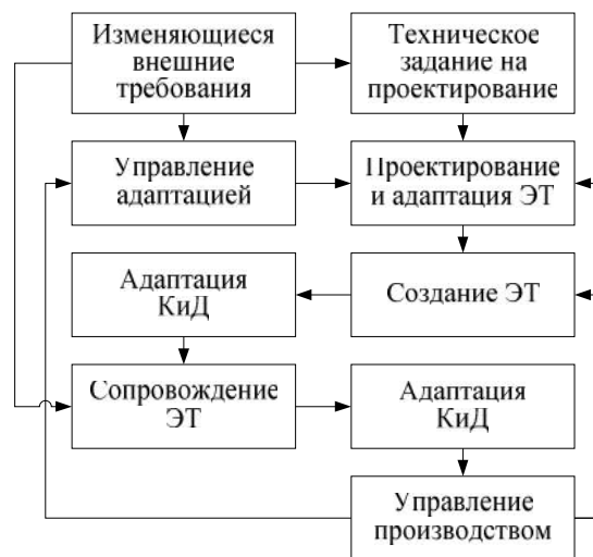
Рис. 4. Структура адаптивного процесса производства ЭТ
